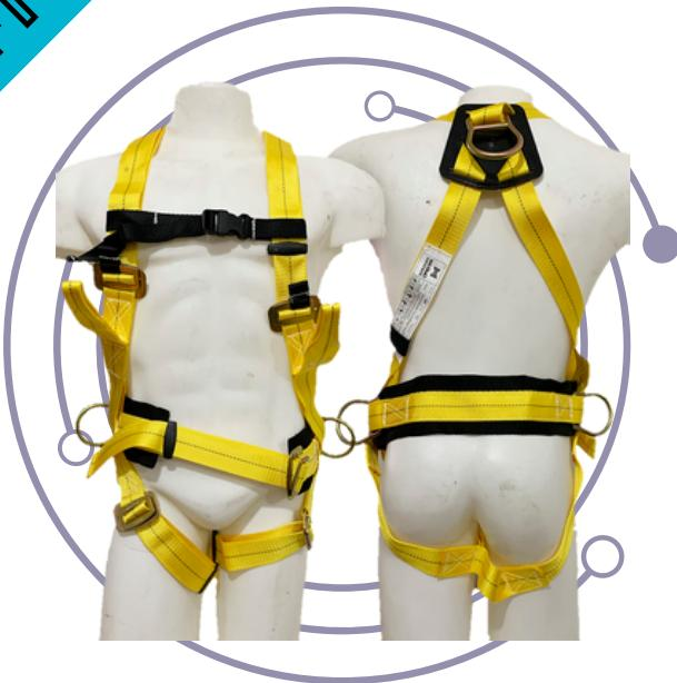
El arnés de 3 puntos de confort incluye un punto anticaídas dorsal, un punto anticaídas frontal y puntos de sujeción y posicionamiento en la cintura. Además, cuenta con un protector lumbar acolchado para mayor comodidad y protección.
